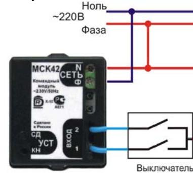
Рис. 2. Схема подключения.
